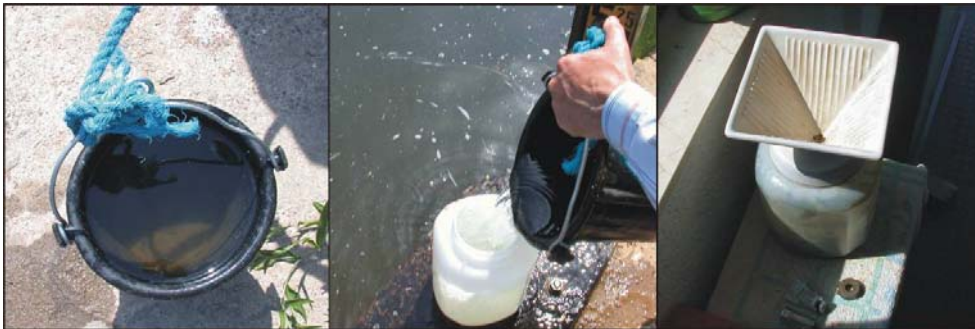
Abbildung B-A2-2-1: Probenahmeverfahren. Probenahmeimer (5 l), Abfüllen der Probe in ein Plastikgefäß (Sonderproben) und der genormte Keramikfilter für die Filtration vor Ort (von links)
