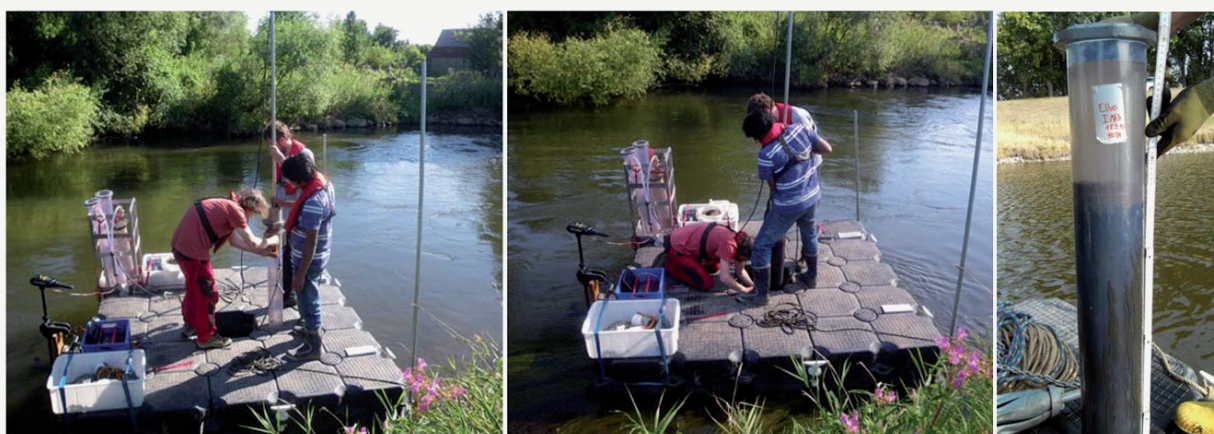
Abbildung B-A2-8-3: Entnahme von Sedimentkernen für die Ermittlung der Erosionsstabilität im Tiefenprofil sowie für die Ermittlung von Zusatzparametern wie Korngrößenverteilung und Lagerungsdichte im Tiefenprofil (IWS 2013a).
