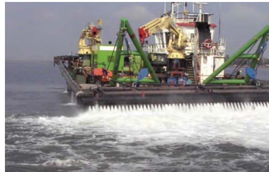
Abb. 3.4: Wasserinjektionsgerät im Einsatz (links) Düsentest oberhalb der Wasseroberfläche (rechts)
