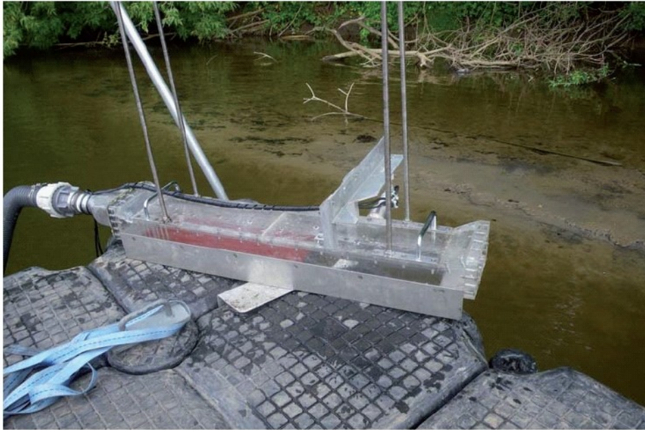
Abbildung B-A2-8-2: Längsgerinne der Universität Stuttgart zur in-situ-Erfassung der kritischen Sohlschubspannung für Erosion (IWS 2013a)
