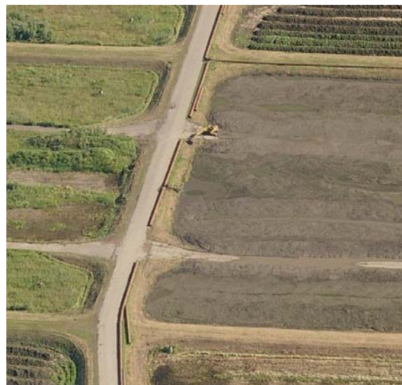
Abb. 6.3: Entwässerungsfeld in Moorburg, Aufsetzung zu Mieten (links), frisch eingespülte Sedimente (rechts) (BING)
