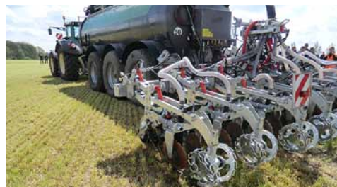
Das Strip-Till-Verfahren – geringere Austräge durch sparsame Unterfußgülleausbringung; Quelle: LELF
