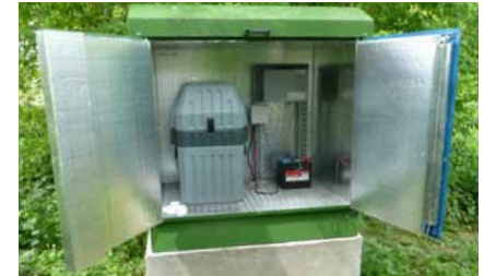
Energieautarke Messstation am Schachtgraben 2012; Quelle: LAF
