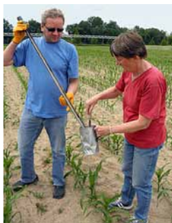
Entnahme von Bodenproben zur Bestimmung des mineralischen Stickstoffs im Boden; Quelle: Dr. Dietmar Barkusky, ZALF e. V.
