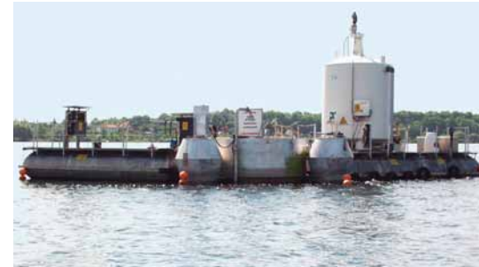
Tiefenwasserbelüftungsanlage; Quelle: IGB
