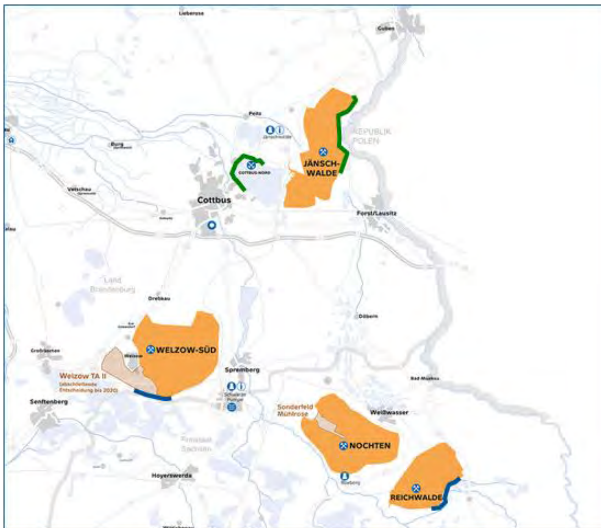
Abbildung 29: Dichtwände im Niederlausitzer Braunkohlenrevier, Quelle: LE-B.
