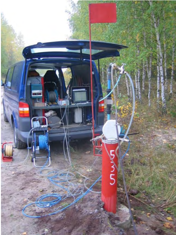
Abbildung 40: Grundwasserprobennahme auf einer Kippe (Foto: Jörn Günther, IWB Possendorf).
