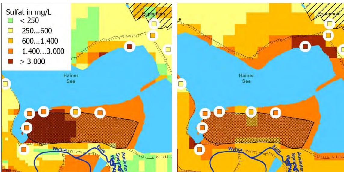
Abbildung 50: Überlagerung der Ergebnisse der numerischen Sulfatprognose für das Jahr 2017 (Flächeninformation links) mit den aktuell gemessenen Sulfatkonzentrationen (Punktinformationen links und rechts) im Bereich des Hainer Sees und Ergebnis der Interpolation (Flächeninformation rechts).
