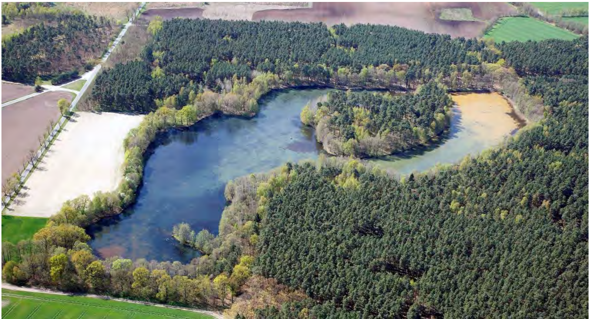
Abbildung 35: Naturräumliche Wasserbehandlung eines eisenreichen, nicht säuregenerierenden Wassers in einer Teichanlage (Heideteich, Foto: Hartmut Rauhut, 2014).
