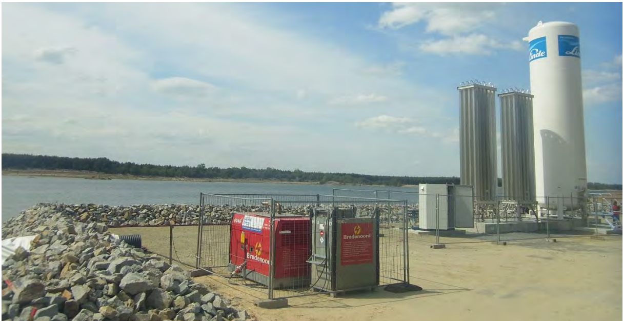
Abbildung 42: Großskaliger Feldtest zur Applikation von \text{CO}_2 in den Lichtenauer See zur Erhöhung der Alkalinität im Mai 2013 (Foto: Seiler, IWB, 2013).
