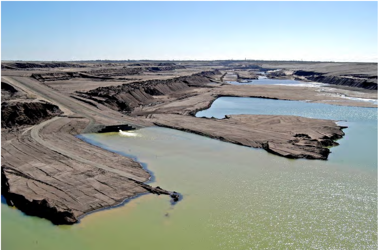
Abbildung 20: Flutung des Restlochs Meuro mit gereinigtem Sumpfungswasser aus der GWRA Rainitz im Jahr 2007, Foto: Peter Radke, LMBV.
