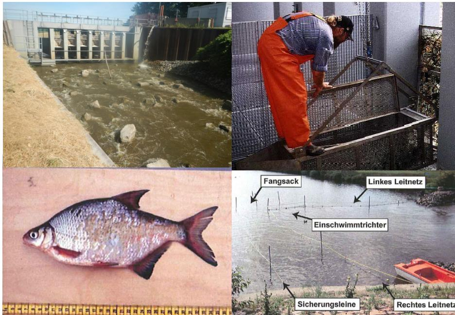
**Abb. 15: Monitoringanlage (o.l.) mit Kontrollreusen (o.r.) und Fischschaden (u.l.) sowie zz. betriebene Garnreuse (u.r.) (SCHUBERT & HAGGE)**
