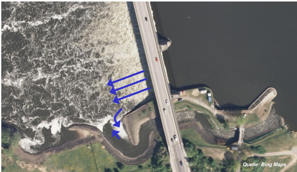
**Abb. 12: Strömungssituation bei geöffnetem Sektor 1**
