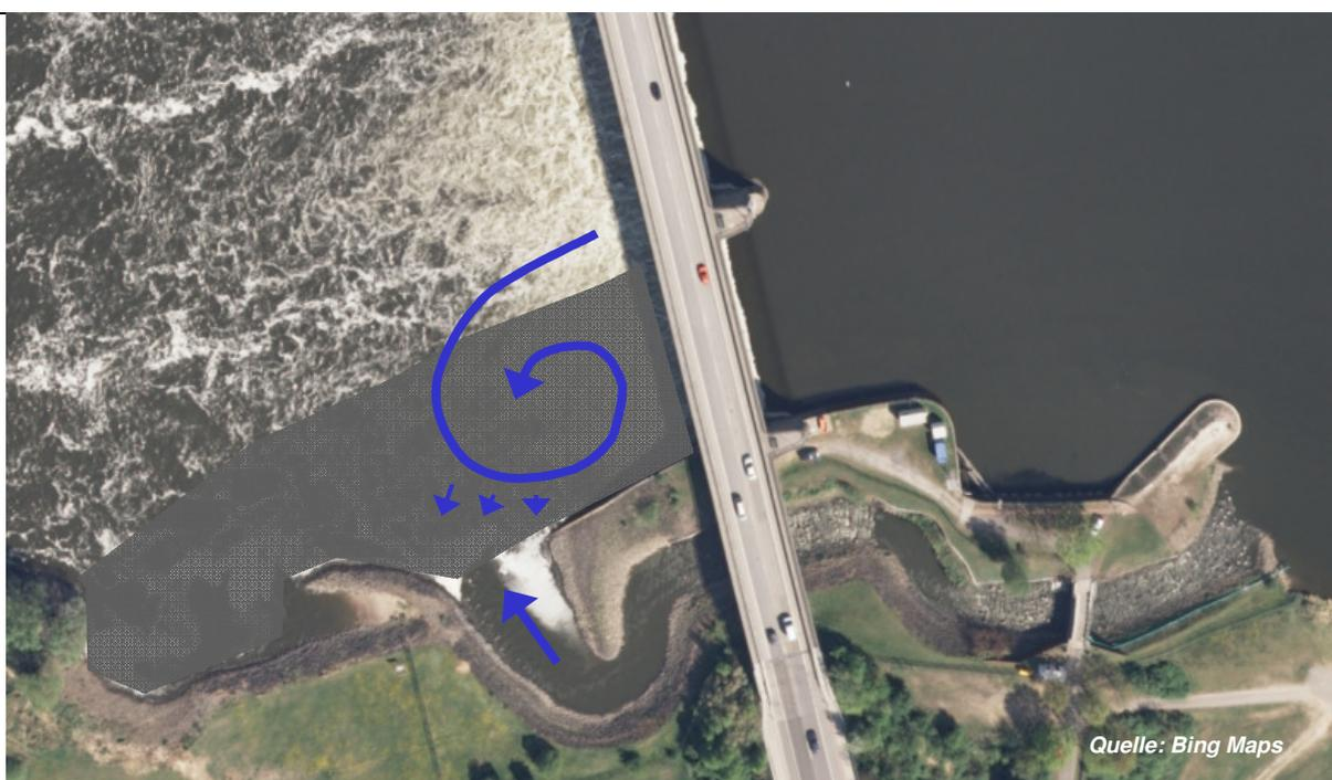
**Abb. 13: Strömungssituation bei geschlossenem Sektor 1**
