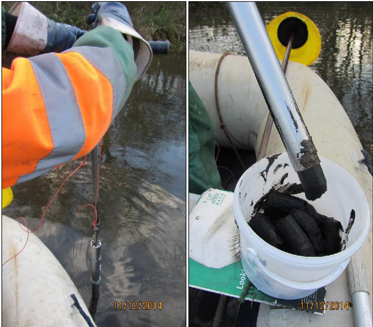
Abbildung 12: Einsatz Pistonsamplers, Sedimentbeprobung Mühlgraben Wettin
