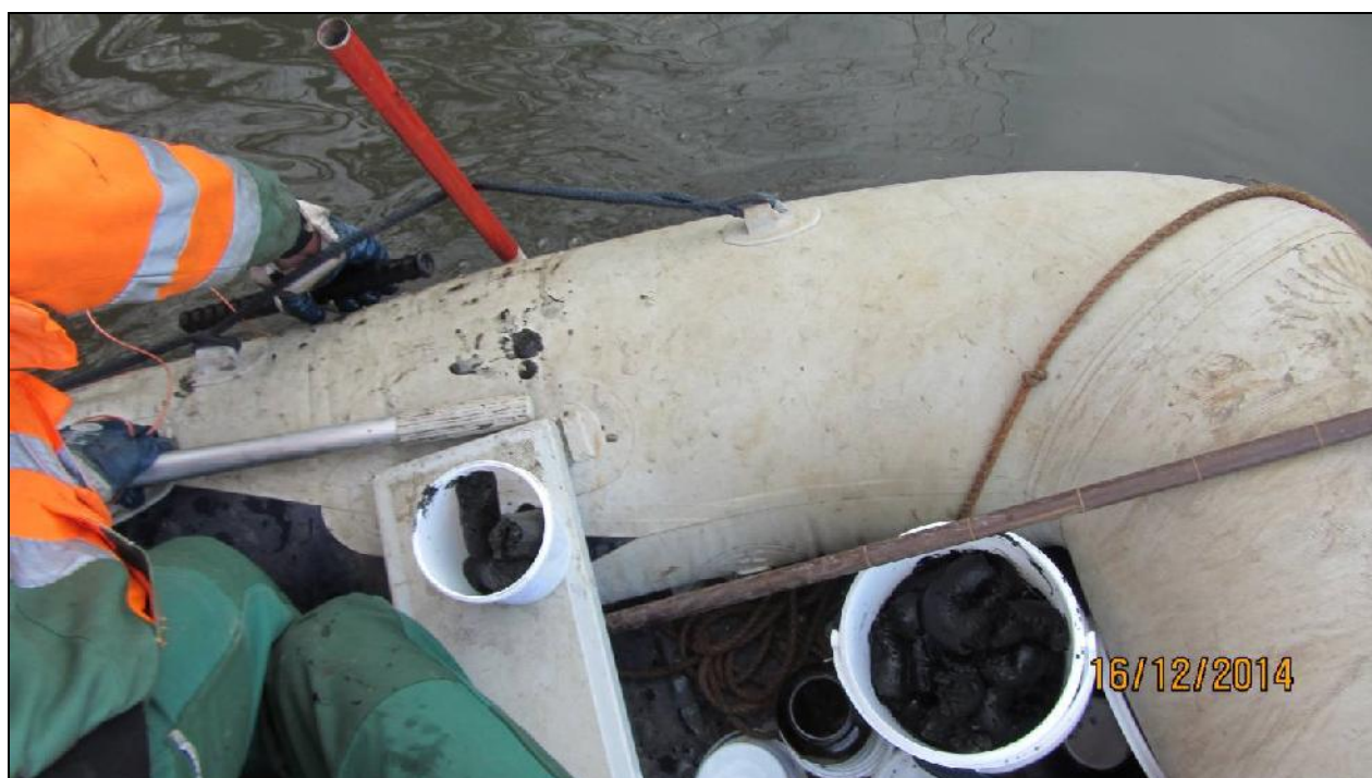
Abbildung 6: Bootfixierung, Schlammprobenahme Mühlgraben Holleben (Beuchlitz)
