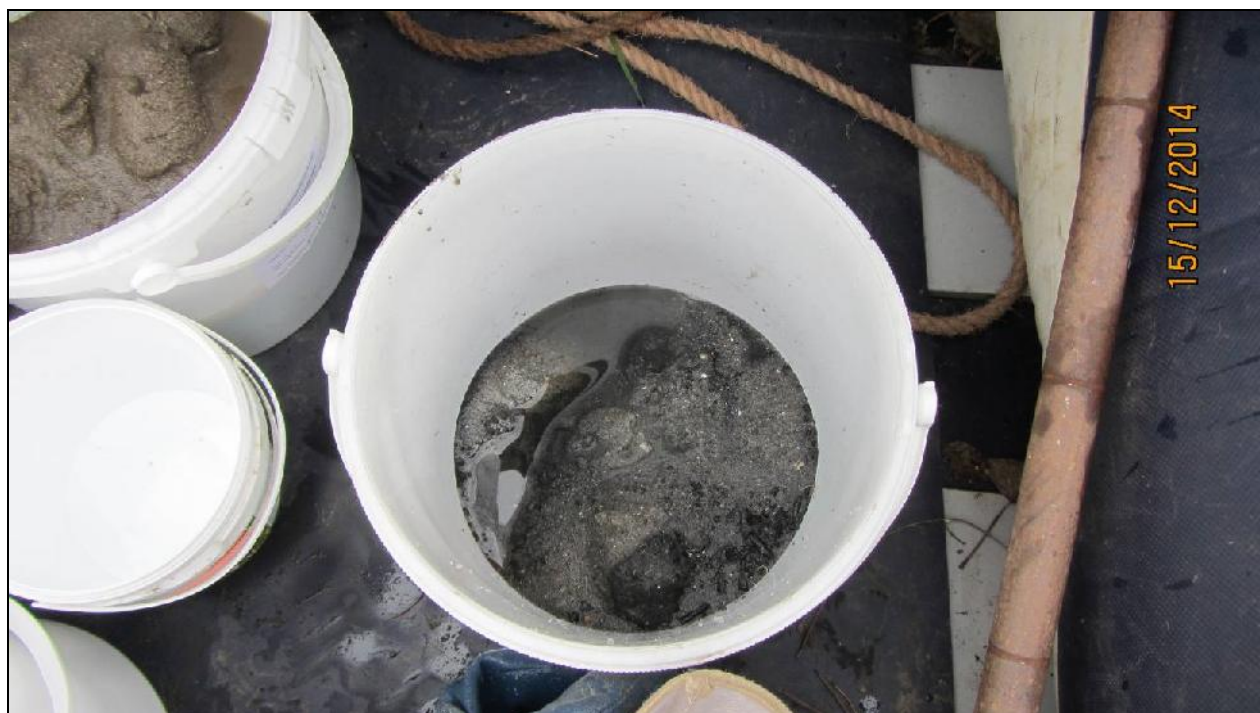
Abbildung 8: stark sandig-kiesige Sedimentproben im Bereich der Wilde Saale Rabeninsel, Sa 07 a-b
