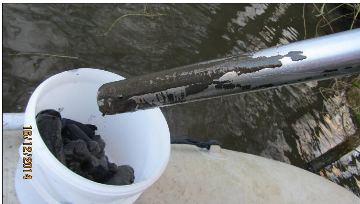
Abbildung 7: exemplarisches frisches Sediment am Pistonsampler, Schlammprobenahme Mühlgraben Halle-Trotha
