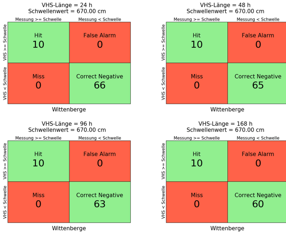
Abbildung B-395: Kontingenztafeln, Pegel Wittenberge, Schwellenwert 670 cm, Vorhersagelänge 24h, 48 h, 96h, 168h, Hochwasser 2013
