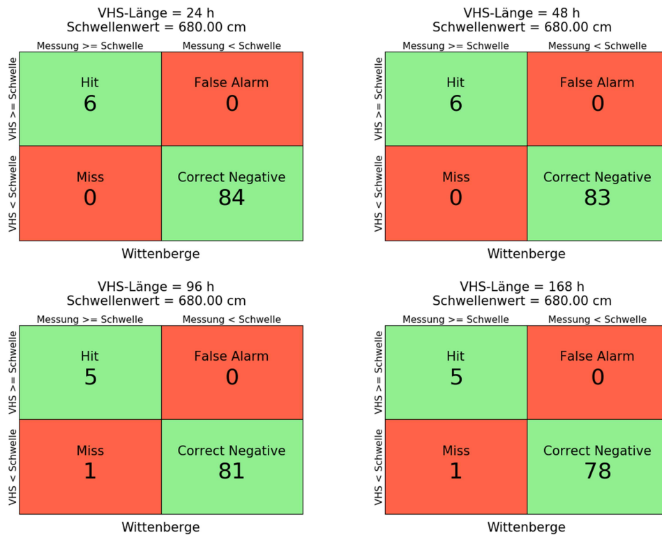
Abbildung B-376: Kontingenztafel, Pegel Wittenberge, Schwellenwert 680 cm, Vorhersagelänge 24h, 48 h, 96h, 168h, Hochwasser 2006
