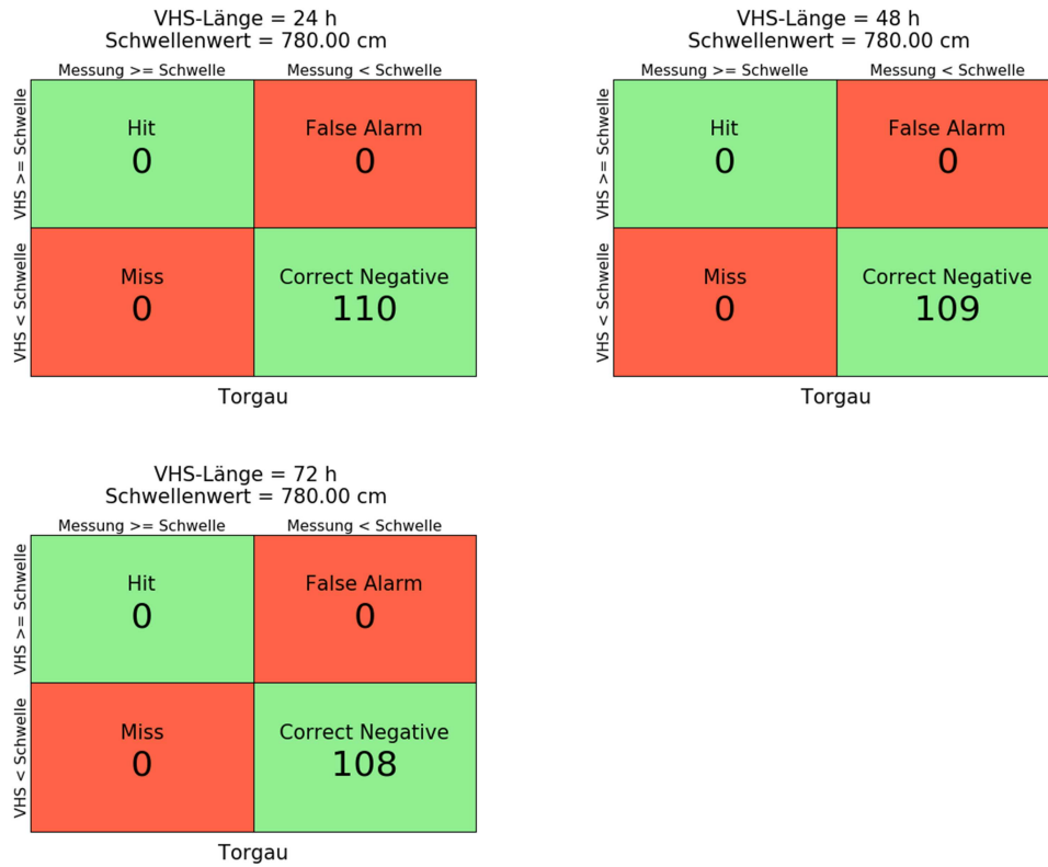
Abbildung B-113: Kontingenztabelle, Pegel Torgau, Schwellenwert 780 cm, Vorhersagelänge 24h, 48 h, 72h, Hochwasser 2011
