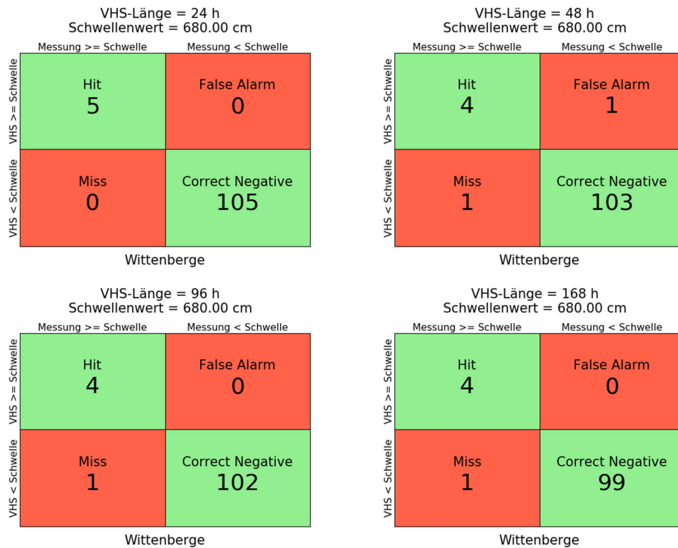
Abbildung B-386: Kontingenztafeln, Pegel Wittenberge, Schwellenwert 680 cm, Vorhersagelänge 24h, 48 h, 96h, 168h, Hochwasser 2011
