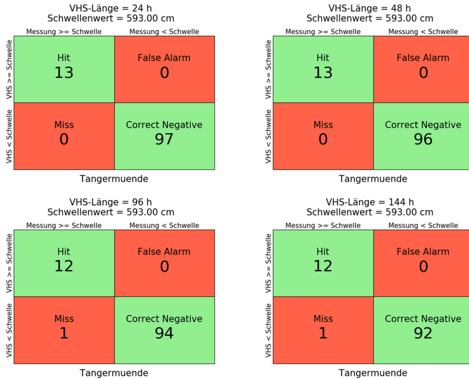
Abbildung B-315: Kontingenztafeln, Pegel Tangermünde, Schwellenwert 593 cm, Vorhersagelänge 24h, 48 h, 96h, 144h, Hochwasser 2011
