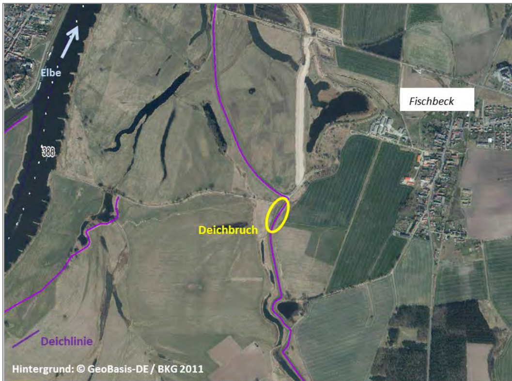
Abbildung 35: Lage Deichbruch Elbe bei Fischbeck (violett: Deichachse, LHW)
