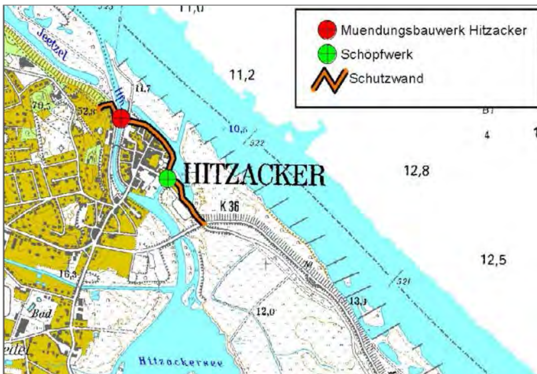
Abbildung 32: Hochwasserschutzsystem Hitzacker, Elbe (Quelle: [NLWKN, 2011])
