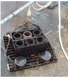
Abb. 4.3: Sedimentationskästen (Beispiele) in den Bundesländern Schleswig-Holstein, Bayern, Umweltprobenbank (UBA), Sachsen (von links nach rechts:)
