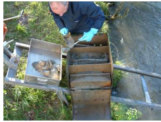
Abb. 4.3: Sedimentationskästen (Beispiele) in den Bundesländern Schleswig-Holstein, Bayern, Umweltprobenbank (UBA), Sachsen (von links nach rechts:)
