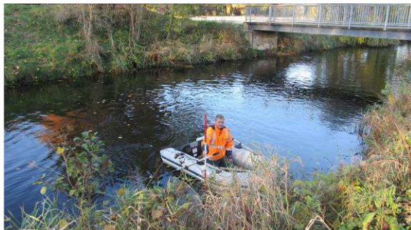
Abbildung 5: Peilstangensondierung Mühlgraben Hohenweiden
