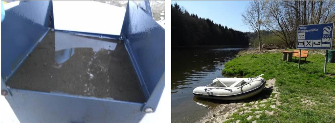
**Abb. 4:** Fotos Blumenaumühle (2) Schlammprobe im Sedimentgreifer und Blick in den Rückstauraum mit Probenahmeboot an einer Bootsanlegestelle
