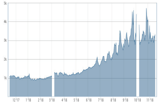
Abbildung 7: Gütemessstation Grauerort (bei Stade) - Ganglinie der elektrischen Leitfähigkeit ( \mu\text{S}/\text{cm} ) in den letzten 12 Monaten (Tagesmittelwerte) – Quelle: https://www.gewaessergueteonline.nlwkn.niedersachsen.de
