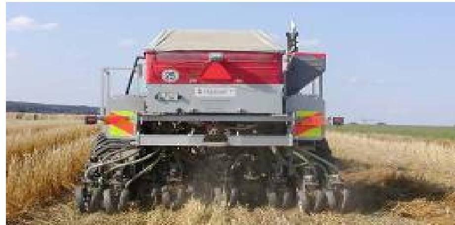
Direktsaatverfahren → Feldbestellung ohne Bearbeitung des Bodens
