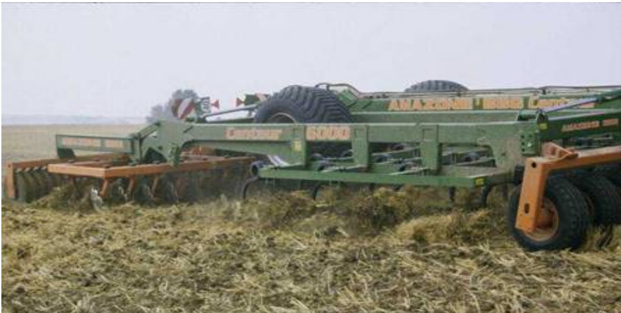
Konservierende Bodenbearbeitung → Nichtwendende Bearbeitung ohne Pflug
